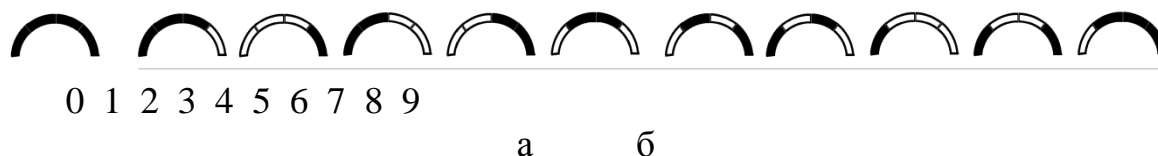
Рис. 10. Цифровой 4-позиционный формат в виде контура дуги (а) и цифровые знаки на его основе (б)
