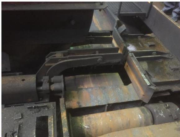
*Рис. 1. Лоток салазковой пилы пакетной резки холодного металлопроката*
