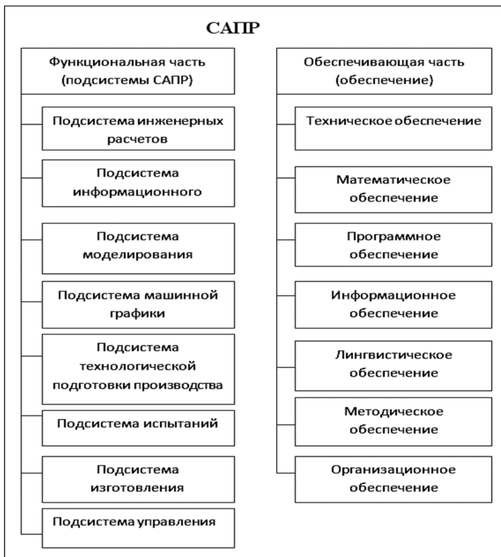
Рис. 1. Структурная схема САПР
