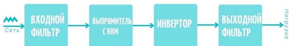
Рис. 1. Структурная схема стабилизатора с двойным преобразованием энергии
