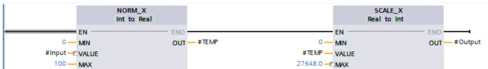
Рис. 4. Масштабирование процентного значения (0-100%) до аналогового сигнала (0-27648).
