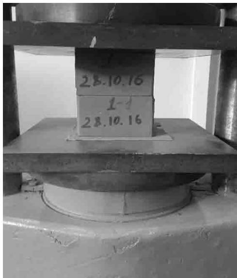
Рис. 4. Испытание на сжатие половинок кирпичей
