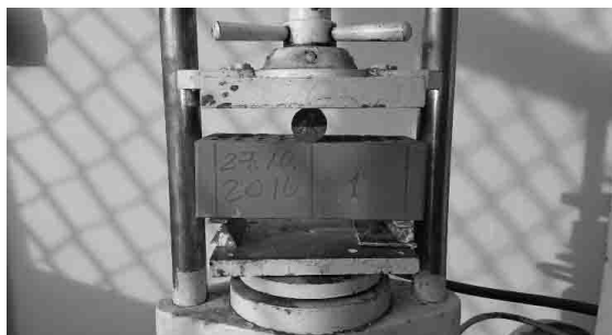
Рис. 2. Схема испытания кирпича на изгиб
