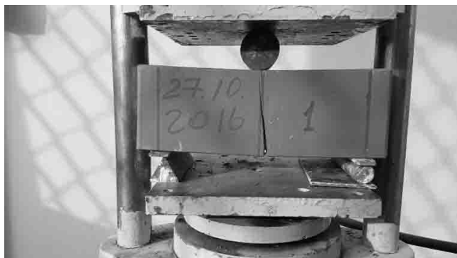
Рис. 3. После испытания кирпич на изгиб
