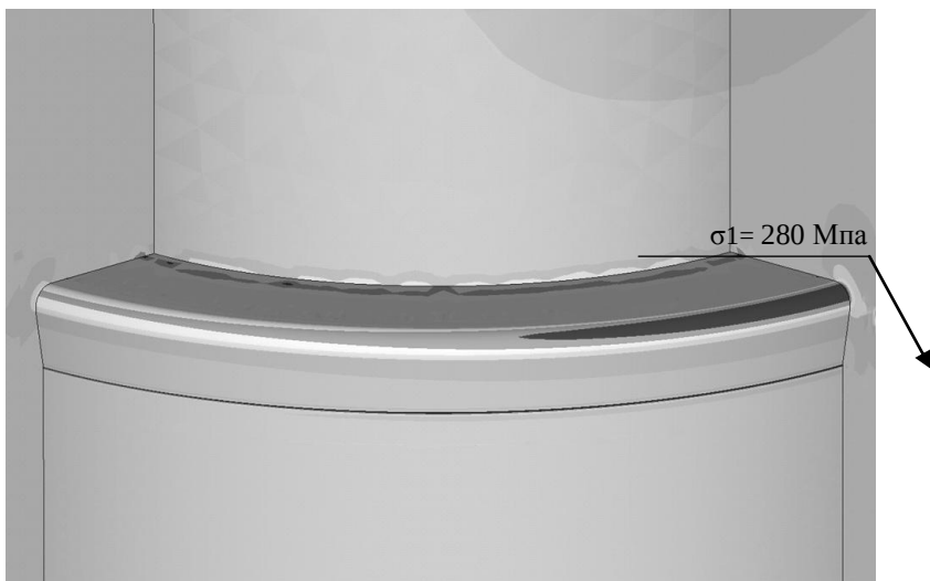
Рис. 2. Напряженное состояние верхней части станины \sigma_1 , МПа
