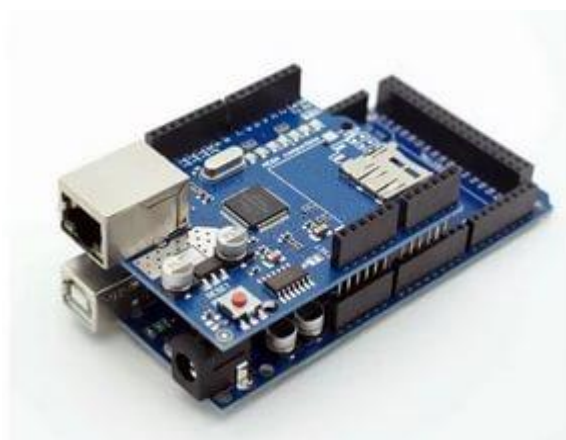
Рис. 3. Подключите Arduino к Ethernet Shield
