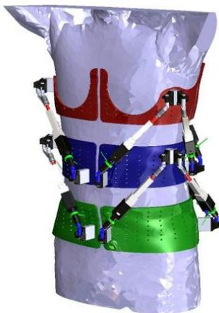
*Рис. 2. Роботизированный экзоскелет для позвоночника*
