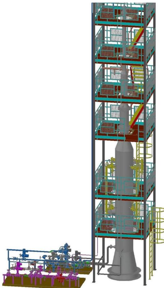
*Рис. 1. Колонна стабилизации газового конденсата*
