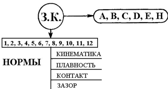
Рис. 3. Мнемосхема «Классификация зубчатых колёс»
