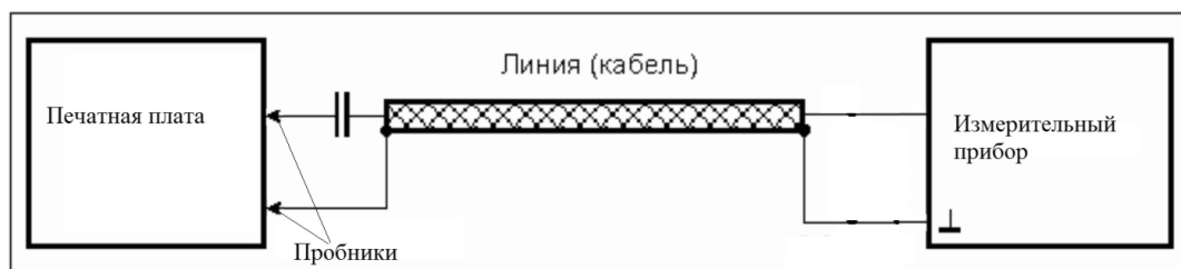
Рис. 6. Схема подключения измерительного прибора
