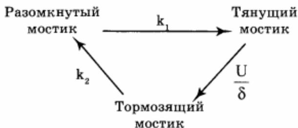
*Рис. 7. Кинематическая модель перехода мостика между различными состояниями ( $k_1$  - const скорости замыкания свободного мостика,  $\delta$  (м) - длина зоны, в которой мостик развивает тянущую силы,  $U$  (м/с) - скорость скольжения нити,  $U/\delta$  - const перехода мостика в тормозящее состояние,  $k_2$  - const скорости распада тормозящих мостиков)*
