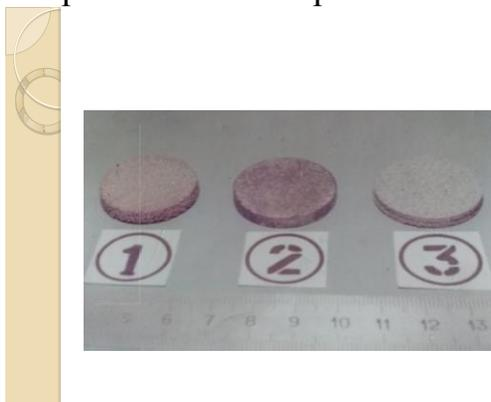
*Рис. 1. Образцы в виде пластин для определения гидравлических свойств ППМ 1-Бронзы марки БрОФ-10-1,2- Нерж.сталь марки ПХ18Н9Т, 3- Титан марки ВТ-9*
