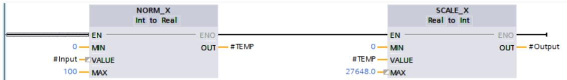
Рис. 4. Масштабирование процентного значения (0-100%) до аналогового сигнала (0-27648).
