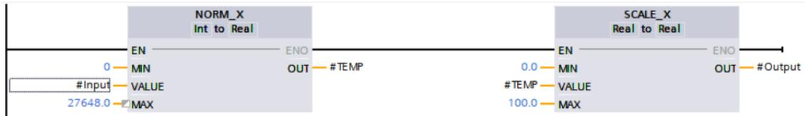
Рис. 5. Масштабирование аналогового сигнала (0-27648) до процентного значения (0-100%).
