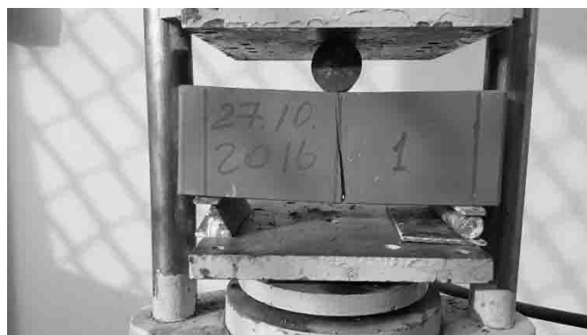
Рис. 3. После испытания кирпич на изгиб
