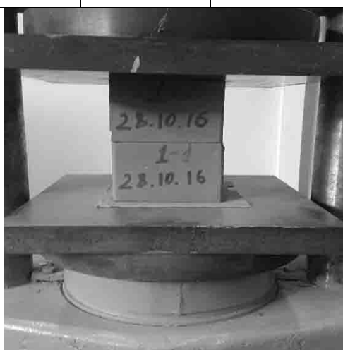
Рис. 4. Испытание на сжатие половинок кирпичей
