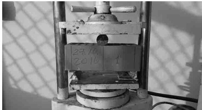
Рис. 2. Схема испытания кирпича на изгиб
